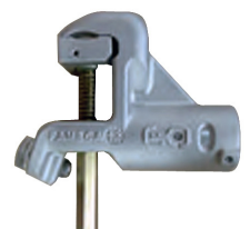
Ref. : SANB2025.. Capacity : Ø20-25mm sur boule ICC max : 31,5kA/1s Weight : 0,75kg
