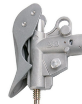
Réf. : SAP1060.. Capacité : Ø10-60mm ICC max : 31,5kA/1s Masse : 1,3kg
