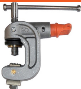
Réf. : SAGTE25 Capacité : 40mm sur plat ICC max : 40kA/1s Masse : 1,8kg
