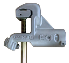
Réf. : SANB2025.. Capacité : Ø20-25mm sur boule ICC max : 31,5kA/1s Masse : 0,75kg
